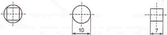
Кут між лініями під час позначення сповіщувачів повинен бути  $60^\circ$  або  $90^\circ$ .
